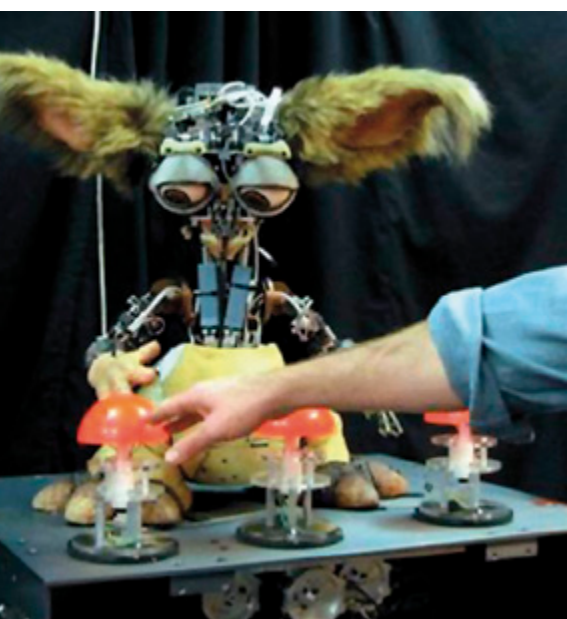
... za koje se brine sustav servoa i žica ispod krznene vanjštine robota
